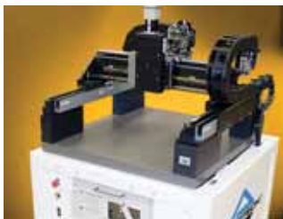
Poste d'inspection de production à grande cadence
